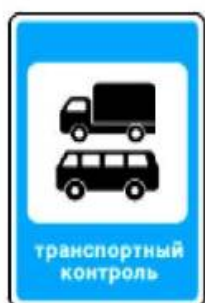
7.14 Пункт контроля международных автомобильных перевозок
